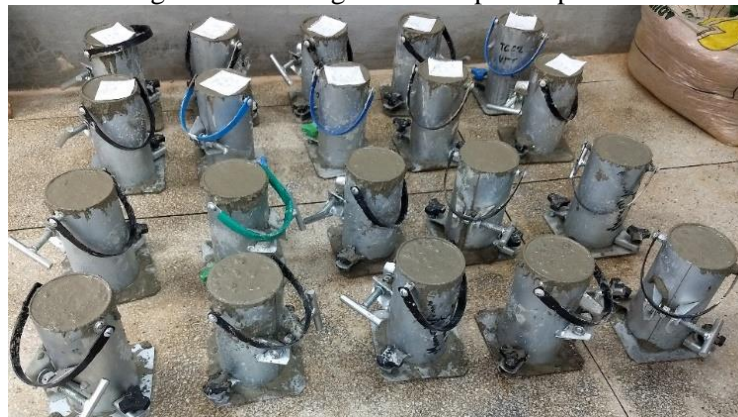
Figura 9 – Moldagem dos corpos de prova.
