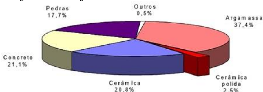
Figura 4 – Porcentagem média dos elementos constituintes do entulho.
