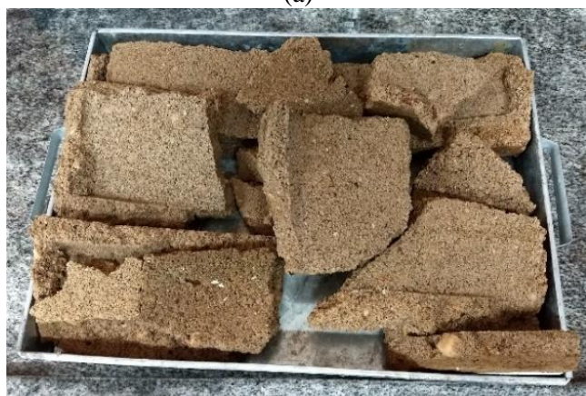
Figura 5 – Tratamento do RCC: a) Separação do material; b) Estufa utilizada na secagem do RCC
