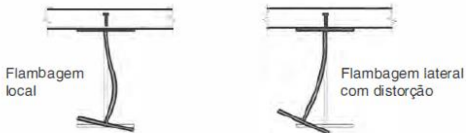
Figura 2 – Flambagem local da mesa inferior, e flambagem lateral com distorção da seção
