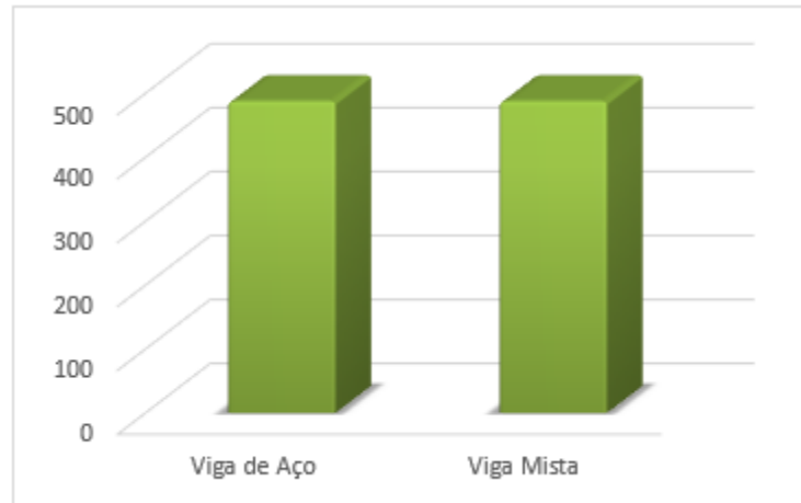
Figura 19 - Gráfico comparativo de esforços cortantes resistentes
