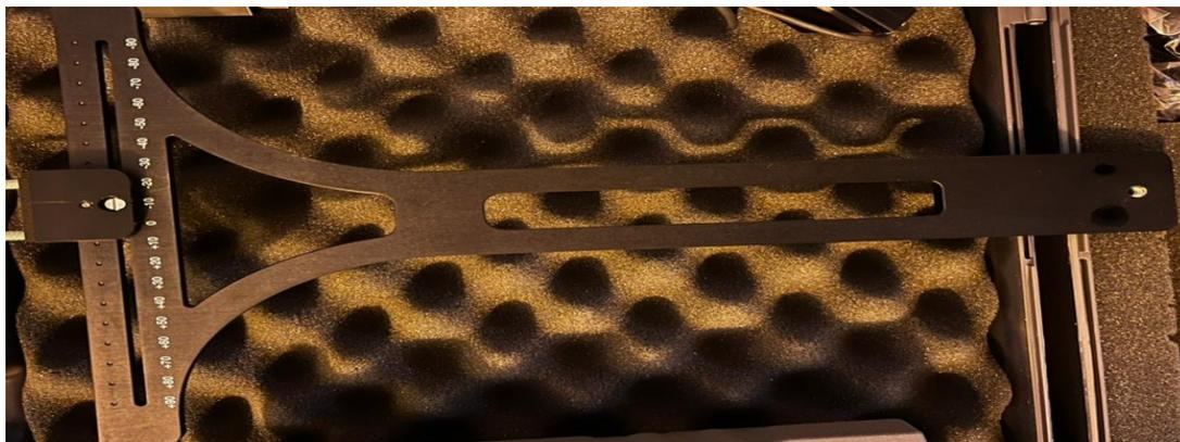
Figura 56. Ferramenta verificação do laser.
