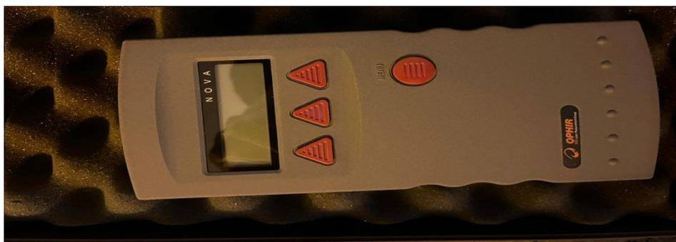
Figura 55. Medidor de potência do laser.
