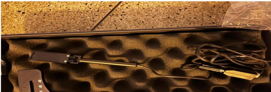
Figura 54. Sensor de potência de calibração do laser.
